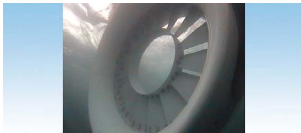
Figura 11.-Imagen de sistema de generación en río fluyente en el cual se integra el generador a la turbina.
