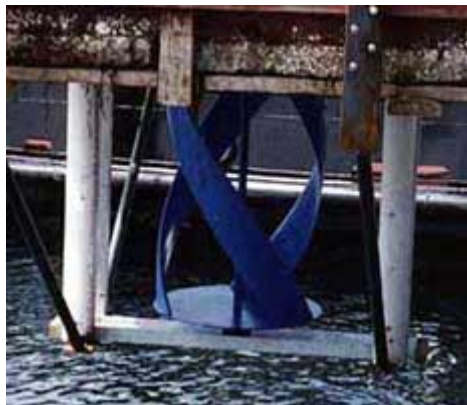
Figura 6.- imagen de turbina para una central hidroeléctrica de río fluyente.
